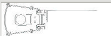
Fixation sur étagère en bois au moyen de vis fixées à travers le châssis en aluminium
