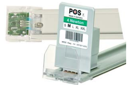
Mit Sensoren ausgestattete Warenvorschübe erkennen Warenzugriffe.
